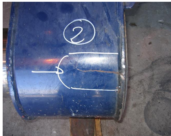
Testata girevole Cricca originata in zona fusa con propagazione nel metallo base Materiale lamiera : S890 QL
